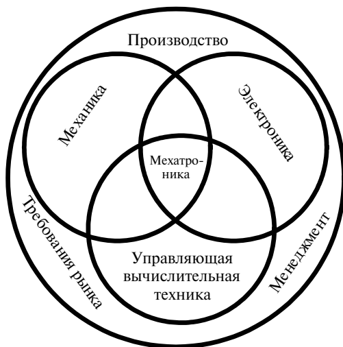
Рис. 1. Определение мехатронных систем
