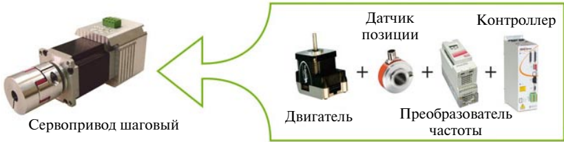
Рис. 3.4. Схема гибридизации привода СПШ 10
