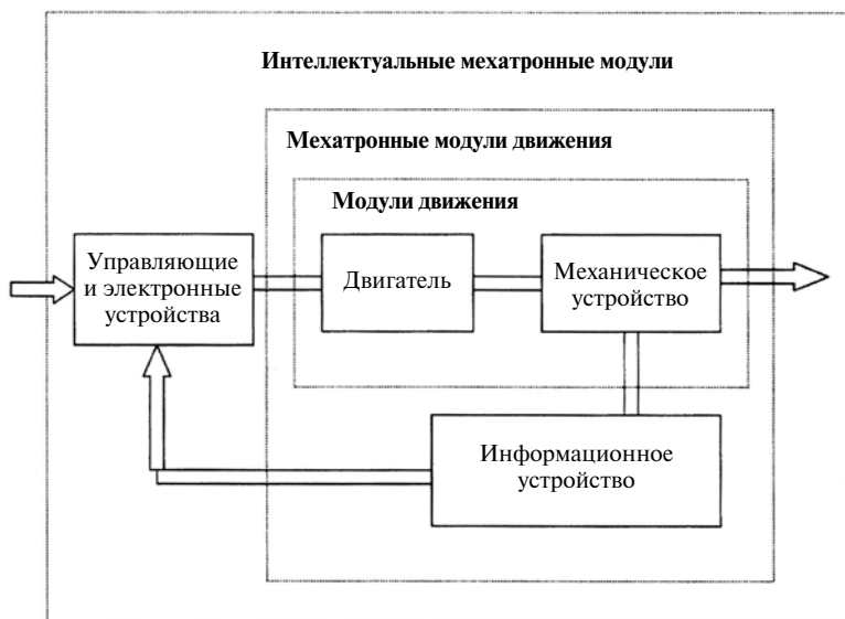
Рис. 2.1. Классификация мехатронных модулей
