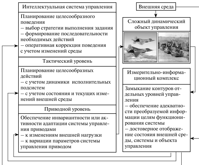
Рис. 4.39. Иерархическое построение системы интеллектуального управления сложным динамическим объектом
