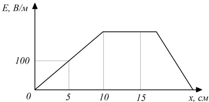
Данное поле переместило частицу массой  $1 \text{ мг}$  и зарядом  $1 \text{ мКл}$  из точки с координатой  $5 \text{ см}$  в точку с координатой  $15 \text{ см}$ . Определить скорость заряда в конечной точке, если в начальной точке она покоилась.
