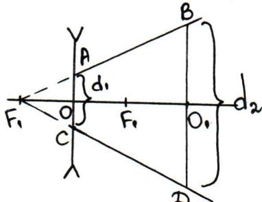
$$\Delta F_1AO \sim \Delta F_1BO, \text{ но } 2L \quad (D = -\frac{1}{f} \text{ для расс. л.})$$
