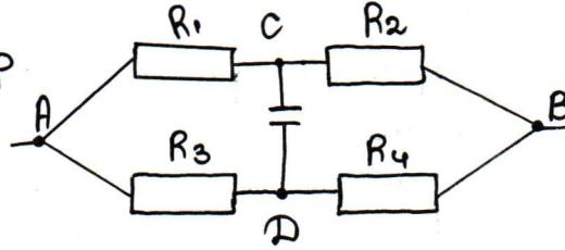
Т.к. по условию задачи сказано, что после подсоединения источника ток прошел достаточно большое кол-во времени, то конденсатор уже успел зарядиться. Следовательно, можно считать, что в установившемся режиме ток через конденсатор не идет.
